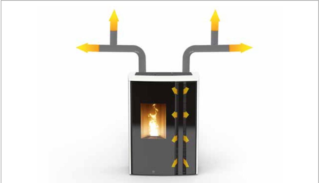
Canaliser un poêle peut être précieux pour optimiser la circulation de la chaleur dans les autres pièces. La gamme 2019 arrive avec de hautes performances de canalisation.
